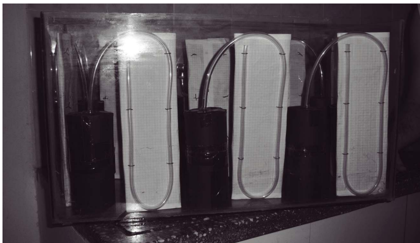
El equipo biodigestor desarrollado permite almacenar hasta diez litros de desechos.
